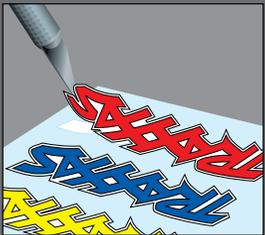
Zum Anbringen der Aufkleber setzen Sie eine Ecke an, halten das andere Ende hoch und streichen den Aufkleber dann mit ihrem Finger in Richtung des anderen Endes. So vermeiden Sie die Bildung von Luftblasen unter dem Aufkleber. Wenn Sie zwei Ecken gleichzeitig aufsetzen und dann versuchen, den Aufkleber zu glätten, werden Sie Luftpneinschlüsse unter dem Aufkleber erhalten. Die Fotos auf der Verpackung zeigen typische Positionen für die Aufkleber.
